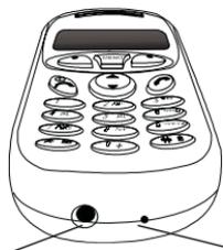
Гнездо для подключения зарядного устройства      Микрофон
