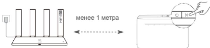
Шаг 2. Когда индикатор на устройстве HUAWEI CPE начнет мигать, нажмите на нем кнопку H. Дождитесь, когда индикатор на роутере укажет на то, что роутер подключен к сети.
