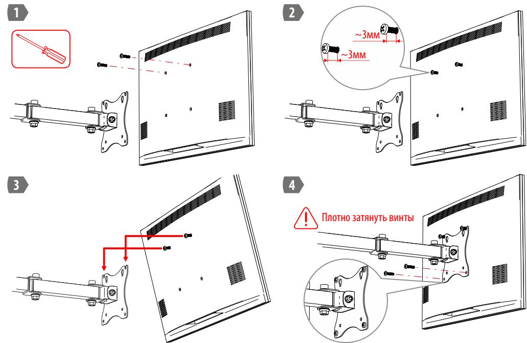
Рисунок 4. Монтаж мониторов на держатель.
