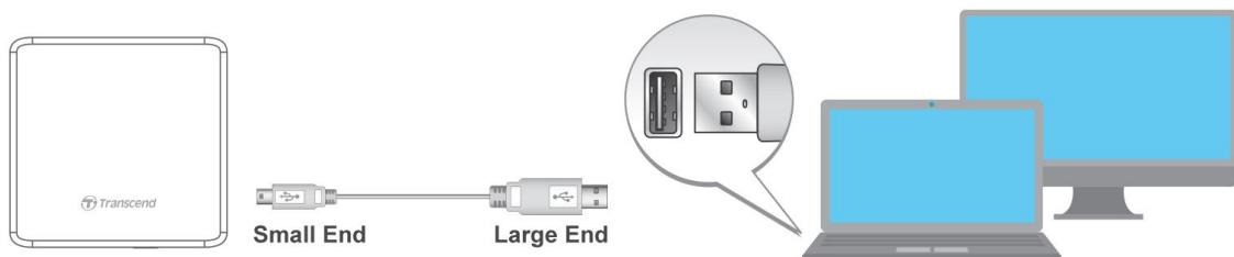
**Примечание: для подключения записывающего DVD-дисковода следует использовать кабель USB из комплекта поставки.**
