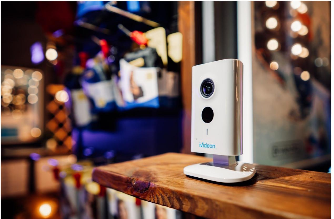
Магнитное основание на сгибающейся ножке и малый вес (всего 140 г) позволяют прикрепить камеру к любому металлическому объекту – даже на двери холодильника. В комплект также включены металлическая монтажная пластина, шурупы и дюбели. Главное – позаботиться о том, чтобы адаптер доставал до розетки и чтобы устройство находилось в зоне Wi-Fi сети.
