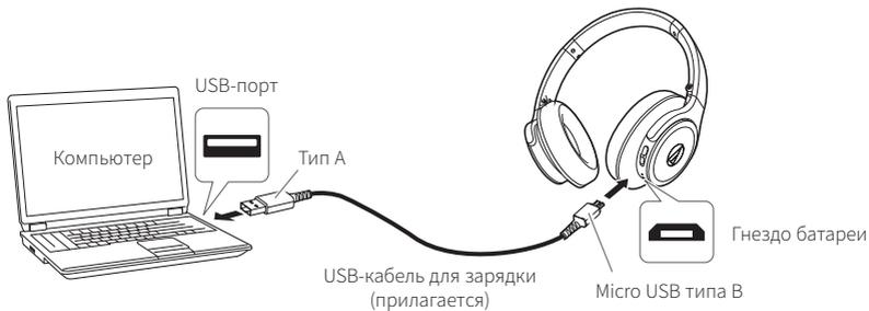
2. Подсоедините прилагаемый USB-кабель для зарядки (разъем USB типа A) к компьютеру, чтобы начать зарядку.
