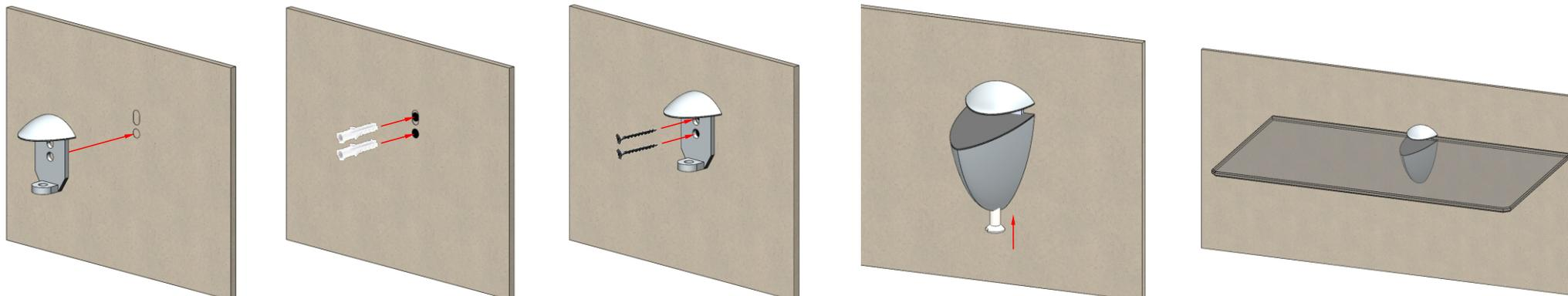
1. Разобрать держатель. Приложить крепежную часть к стене и через отверстия наметить места сверления
