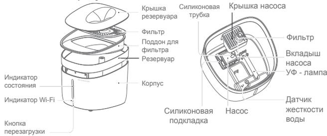
**Как работает стерилизация:** Ультрафиолетовое излучение трубки на дне фонтана уничтожает ДНК бактерий и других микроорганизмов, что приводит к их гибели. Цикл стерилизации занимает 3 минуты. За это время излучение убивает до 99,7% бактерий.
