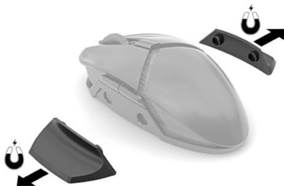
2. Установите заглушку упора для большого пальца так, чтобы сработало магнитное крепление.
