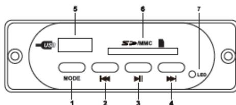
1. MODE – переключение между источниками аудио сигналов: FM-радио; MP3-плеер(USB); MP3-плеер (SD-карта); внешний источник, подключенный по AUX-кабелю 3.5мм.
