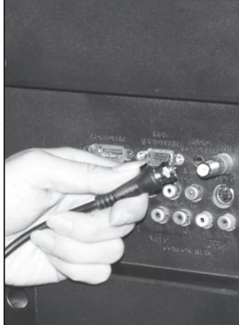
Подключить коаксиальный кабель к гнезду входа РЧ (RF).
