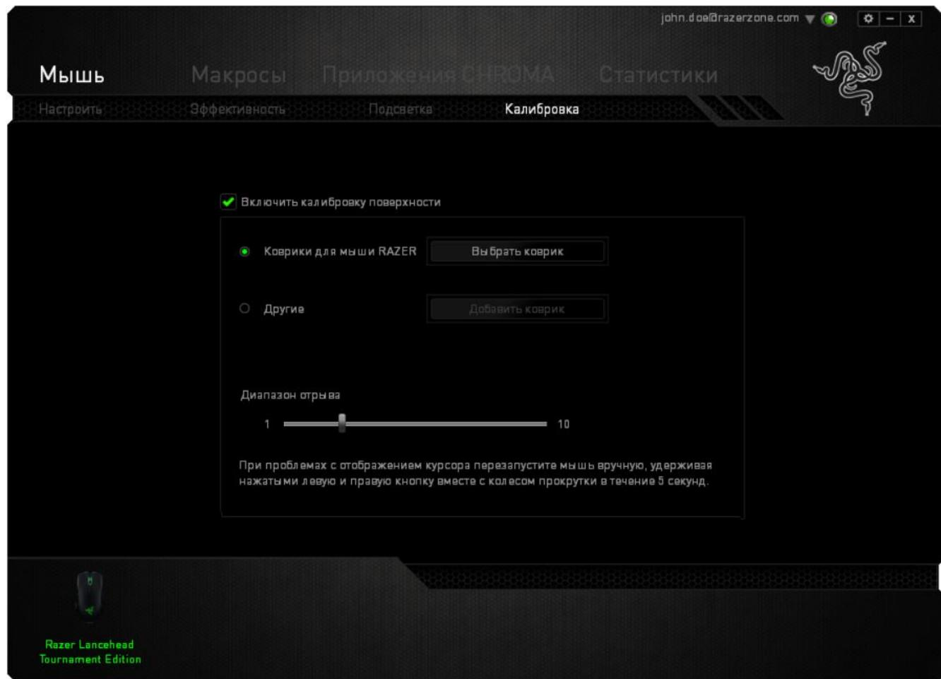
Параметр ДИАПАЗОН ОТРЫВА позволяет задать значение расстояния, при котором датчик перестает функционировать при отрыве мыши от рабочей поверхности. Чтобы использовать данную возможность, сначала необходимо активировать параметр КАЛИБРОВКА ПОВЕРХНОСТИ, а затем выбрать соответствующую рабочую поверхность.
