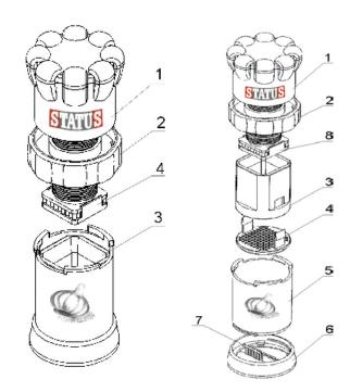
Теперь измельчитель для чеснока закрыта и готова к использованию. Держите дно в левой руке и закручивайте винтовой механизм (часть 1) в правую сторону. Пластинка опускается и проталкивает зубчики чеснока через решетку из нержавеющей стали, разрезая их небольшими лезвиями и идеально измельчая чеснок с каждым поворотом. Работает по принципу перцемолки.
