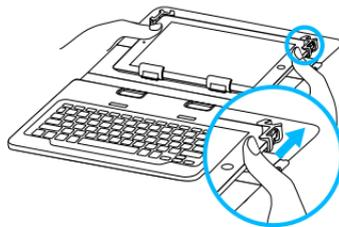
3 Поднимите нижнюю часть планшета и освободите его из верхних фиксаторов:
