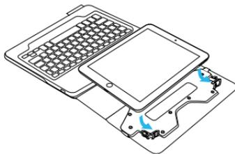
Если планшет слишком большой, сначала вставьте в фиксатор его левый угол, слегка прижмите вверх, а затем вставьте в фиксатор правый угол.
