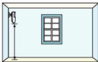
Высота монтажа датчика от 2,1 до 2,5 м над уровнем пола.
