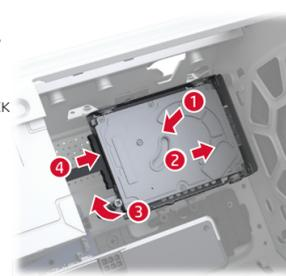
**4** Чтобы установить на место съемную панель, поверните ее до фиксации на месте.
