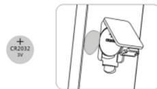
Откройте отсек для батарейки на корпусе светильника и извлеките пластиковую изоляцию, затем закройте отсек.
