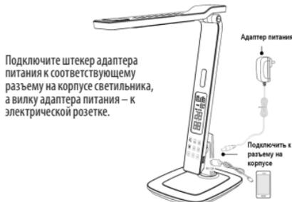
Подключите штекер адаптера питания к соответствующему разъему на корпусе светильника, а вилку адаптера питания – к электрической розетке.
