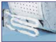
Поврежденный элемент Пошкоджений нагрівальний елемент Зақымданған элемент
