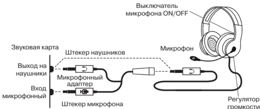
Рис. 1. Схема подключения
