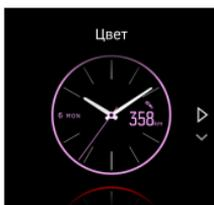
На каждом циферблате есть дополнительная информация, например, дата или второй часовой пояс. Изменять эти представления можно касанием дисплея.
