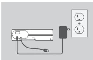
2. Подключите адаптер питания к разъему питания на задней панели DUB-1342, затем подключите адаптер питания к электрической розетке.
