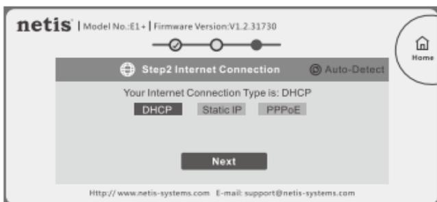
**Примечание.** Устройство E1+ поддерживает указанные ниже три типа подключения к сети Интернет.
