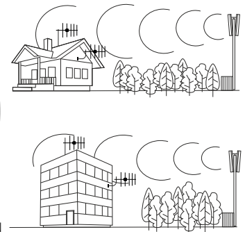
Рис.4 Варианты установки приемно-передающей антенны.
