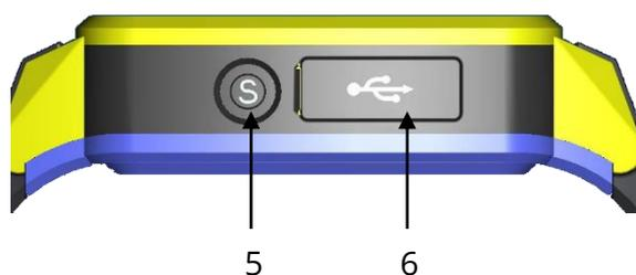
5 — Кнопка SOS. Длительное нажатие (более 3-х секунд) применяется для активации сигнала тревоги SOS, в этом случае на экране появляется буква «S». Устройство начинает обновлять местоположение по GPS/LBS в приложении каждые 10 секунд и осуществлять набор каждого заданного номера по очереди. Весь процесс длится в течение 5 минут; короткое нажатие применяется для просмотра SMS-сообщений от разрешенных телефонных номеров.
