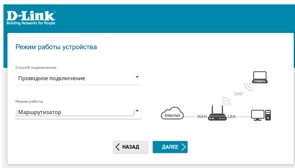
Рисунок 25. Выбор режима работы устройства. Режим Маршрутизатор .
