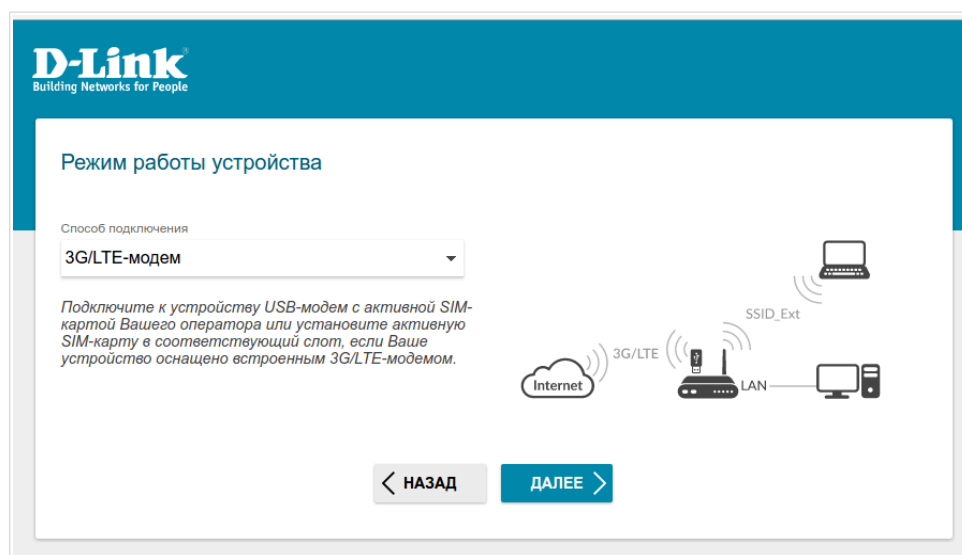
Рисунок 26. Выбор режима работы устройства. Режим 3G/LTE-модем .
