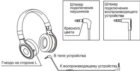
При выполнении соединения обязательно полностью вставляйте штекер в гнездо. Если штекера вставлены в обратной ориентации или не полностью вставлены в гнезда, звук может прерываться и кнопки управления могут не работать должным образом.
