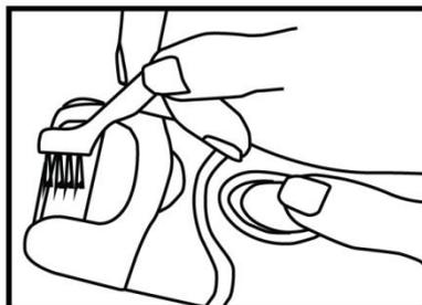
Для тщательной очистки рекомендуется снять шлифовальный ролик и вычистить щёткой сам ролик и место его установки.
