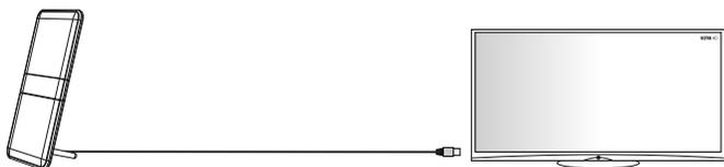
Рис.3 Подключение антенны к телевизору с тюнером DVB-T2 и питанием усилителя антенны через коаксиальный кабель от телевизора
