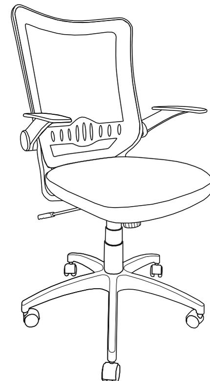
Примечание шаг 2: Для сборки необходимо совместить отверстия спинки с отверстиями сиденья. Вставить винты (позиция 9) в отверстия и закрутить поочередно, не затягивая их до конца. После закрутить все винты до полной фиксации спинки и сиденья.
