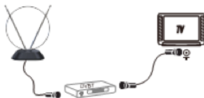
(рис. 2) Подключение через DVB-T2 приемник
