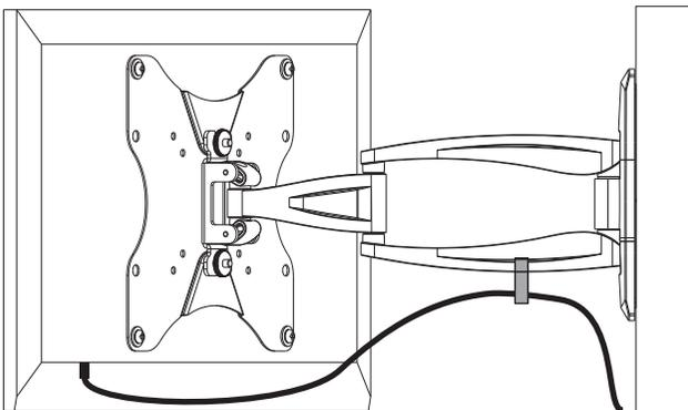
подключите провода к Вашему телевизору и зафиксируйте их при помощи кабельного зажима
