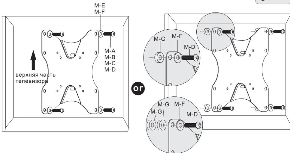
**Примечание:** выберите соответствующие винты, шайбы и распорки (при необходимости) в соответствии с типом экрана. Привинтите пластину VESA к телевизору.
