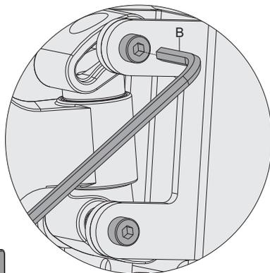
В зависимости от массы телевизора необходимо немного ослабить или затянуть регулировочные винты с помощью шестигранного ключа
