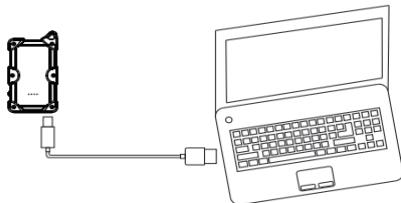
**Важно:** Первый раз зарядите ваш PB-0010 в течение полных 8 часов перед регулярной эксплуатацией. После первой зарядки обычная зарядка займет примерно 6 часов.
