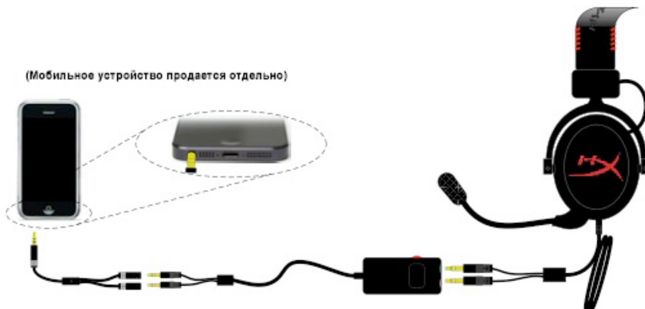
*Рисунок 1.14 – Использование с мобильным устройством (телефоном или планшетом)*
