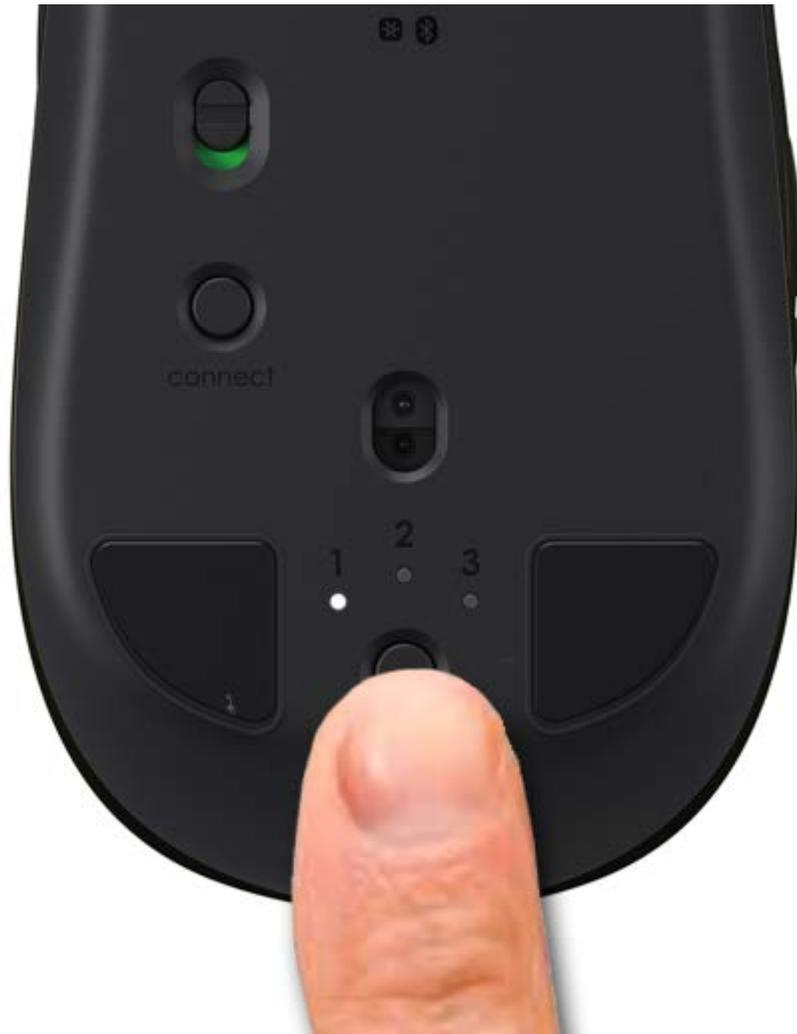
**Для последовательного переключения между тремя доступными каналами нажимайте кнопку Easy-Switch.**
