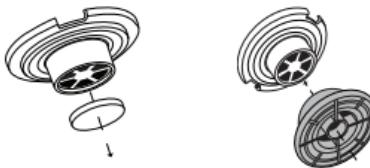
1. Odstraňte protiskluzové podložky z nožiček váhy.
