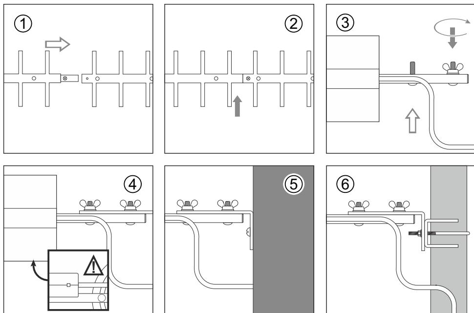
**Рисунок 2. Сборка и монтаж «Ультра 3G&4G»**
