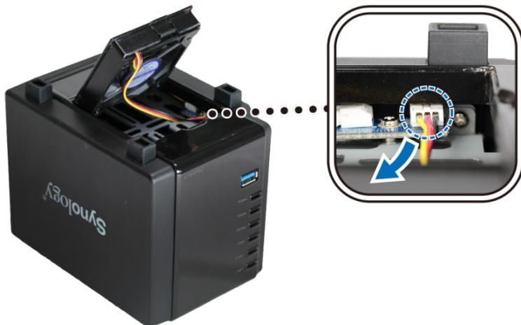
**4** Извлеките винты из отсека вентилятора и извлеките неисправный вентилятор.
