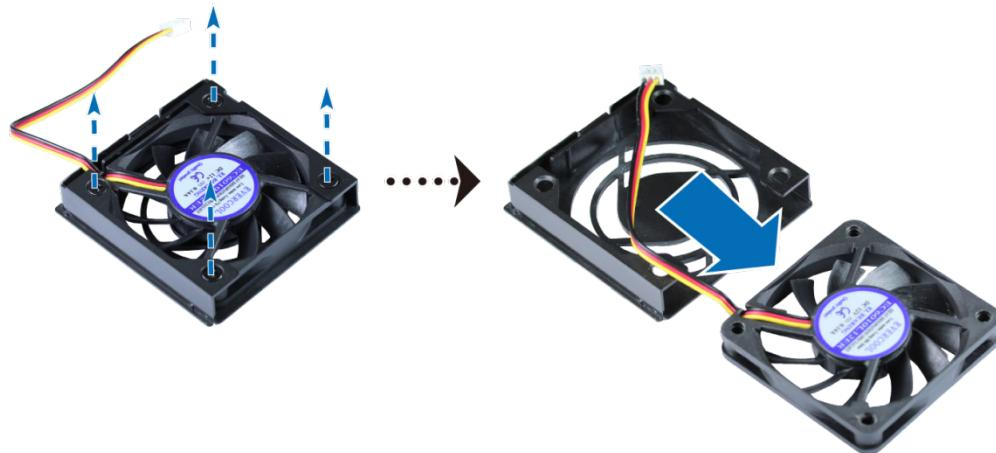
**5** Установите в корпус новый вентилятор. Затем затяните винты для фиксации вентилятора на месте.
