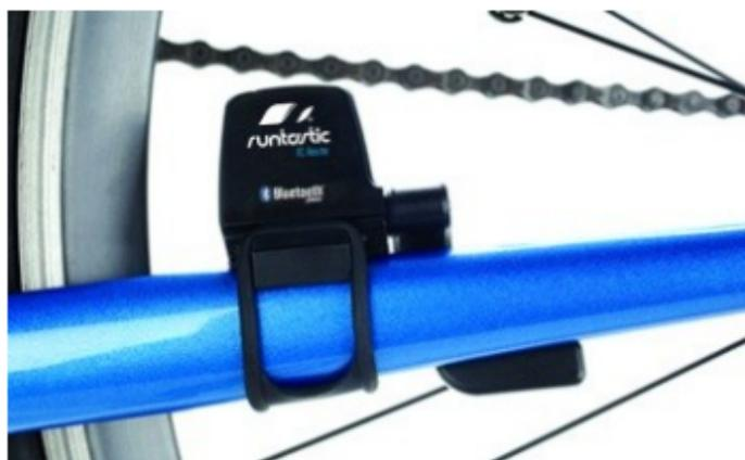
2. Проденьте хомуты через проушины в корпусе датчика, установите датчик на пере логотипом наружу, но пока не затягивайте
