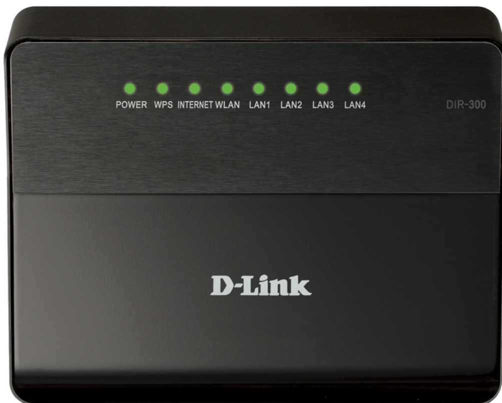
Рисунок 1. Вид передней панели DIR-300.
