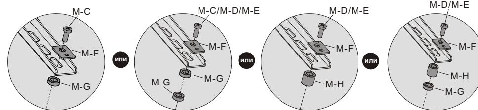
**Примечание:** Подберите винты, шайбы и распорки в соответствии с типом экрана.
