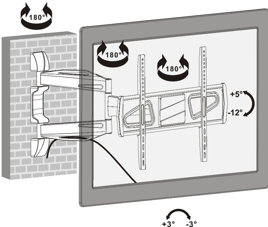
Отрегулируйте желаемое положение и наклон.
