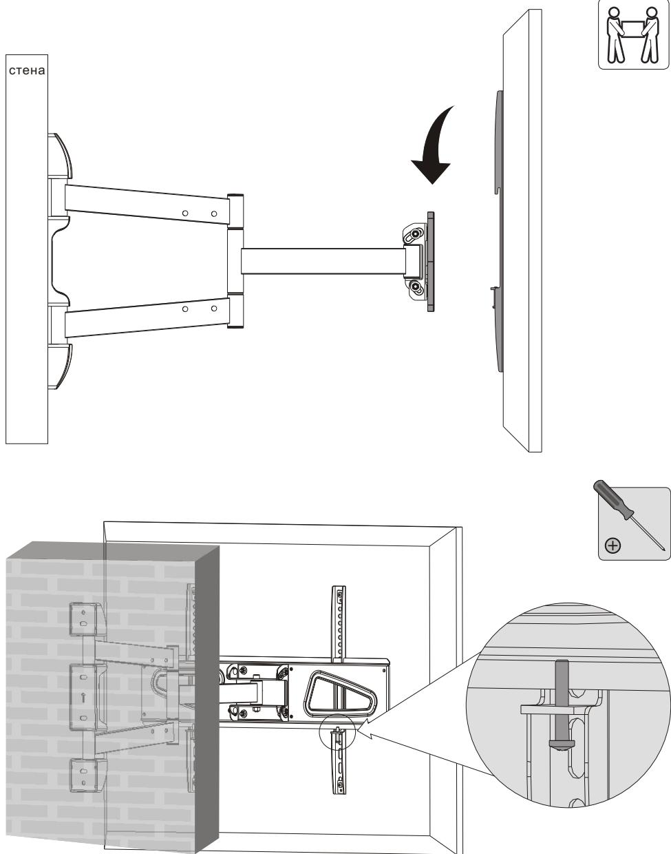
Затяните два болта, используя крестовую отвертку, чтобы закрепить кронштейн.
