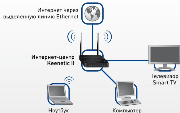
Подключение по выделенной линии Ethernet
