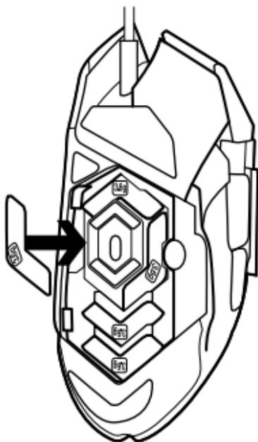
Внутри отсека можно разместить до пяти небольших гирек весом 3,6 грамма в разных положениях. Разместите гирьки в разных положениях, чтобы добиться нужного баланса общего веса.
