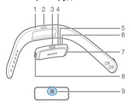
1 Браслет 2 Крышка клавиши питания 3 Клавиша питания 4 Индикатор уведомлений А 5 Индикатор уведомлений В 6 Индикатор уведомлений С 7 Core 8 Порт Micro USB 9 Зона обнаружения NFC
