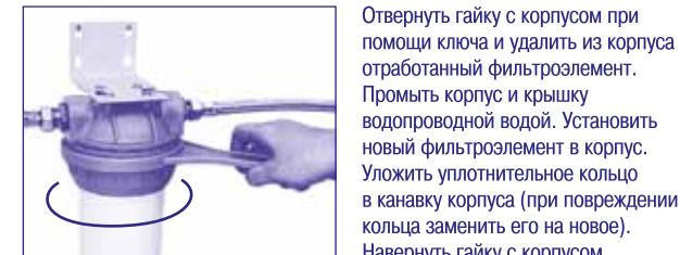
Отвернуть гайку с корпусом при помощи ключа и удалить из корпуса отработанный фильтроэлемент. Промыть корпус и крышку водопроводной водой. Установить новый фильтроэлемент в корпус. Уложить уплотнительное кольцо в канавку корпуса (при повреждении кольца заменить его на новое). Навернуть гайку с корпусом
