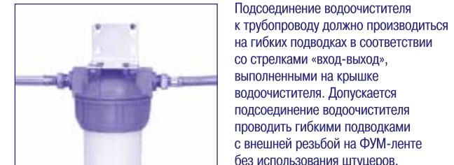
Подсоединение водоочистителя к трубопроводу должно производиться на гибких подводках в соответствии со стрелками «вход-выход», выполненными на крыше водоочистителя. Допускается подсоединение водоочистителя проводить гибкими подводками с внешней резьбой на ФУМ-ленте без использования штуцеров.
