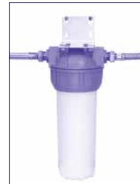
Подсоединение водоочистителя к трубопроводу должно производиться на гибких подводках в соответствии со стрелками «вход-выход», выполненными на крышке водоочистителя. Допускается подсоединение водоочистителя проводить гибкими подводками с внешней резьбой на ФУМ-ленте без использования штуцеров.
