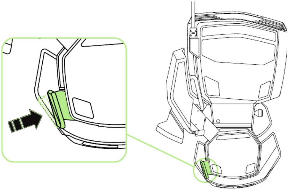
2. Передвиньте нижнюю часть Orbweaver в вертикальном направлении для регулировки.
