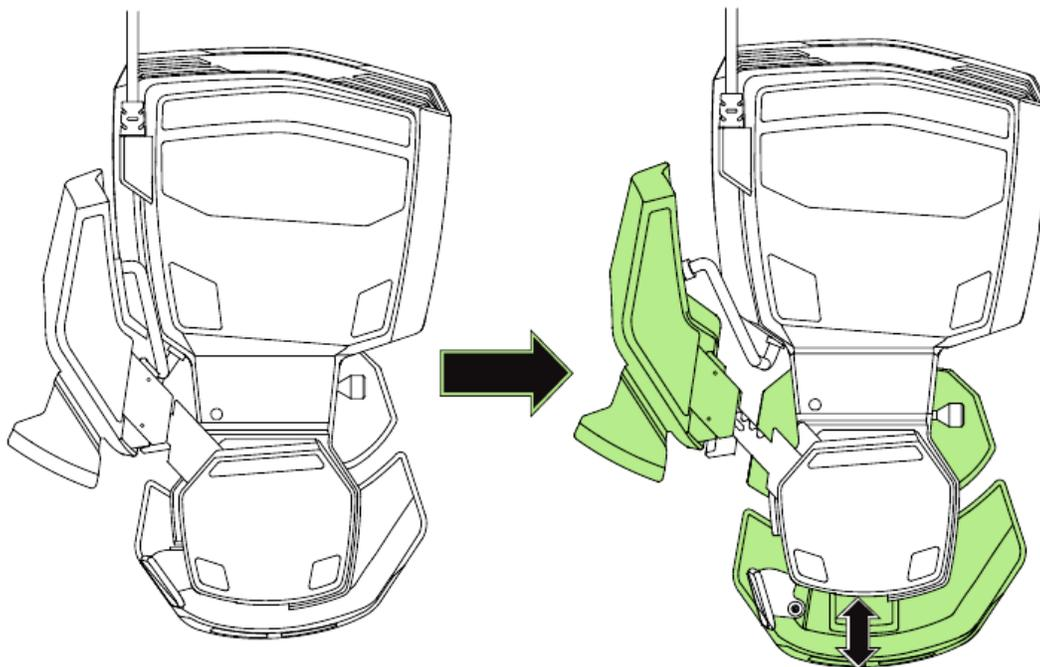
3. Отпустите рычаг, чтобы зафиксировать положение нижней части.
