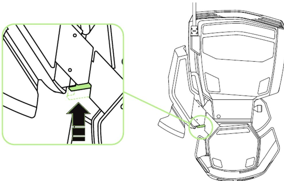
2. Передвиньте упор для большого пальца по диагонали для регулировки.
