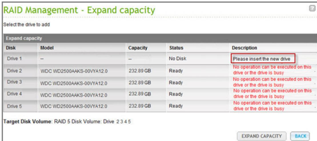
После установки жесткого диска дождитесь воспроизведения NAS-системой звукового сигнала. Система начнет перестройку дискового массива.
