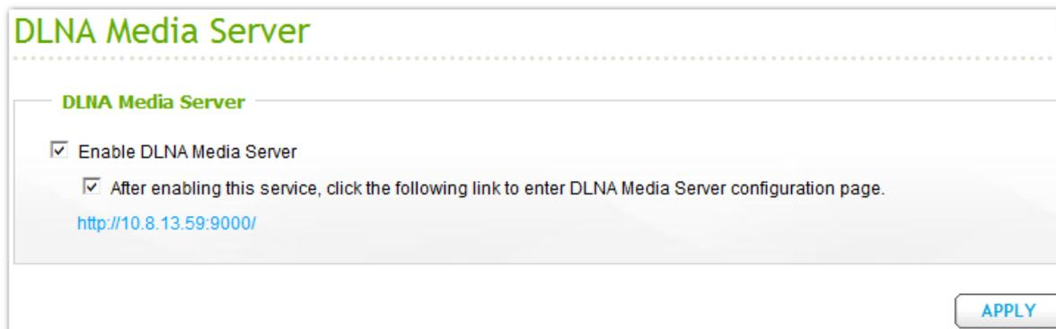
Щелкните ссылку <http://IP-адрес NAS:9000/>. Перейдите в «Настройки TwonkyMedia» > «Базовые настройки» для конфигурации базовых серверных настроек.
