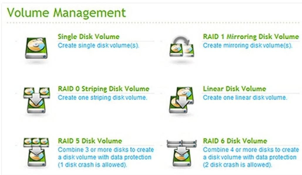
4. Выберите жесткий(-ие) диск(-и) для создания дискового тома. В этом примере мы выбрали создание одиночного диска. Процедура так же относится к конфигурации RAID.
