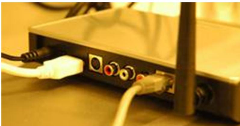
Если телевизор не оснащен интерфейсом HDMI, видеовыход можно подключить к телевизору посредством кабеля S-Video, а аудиовыход можно подключить ко входам левого и правого аудиоканалов композитного входа телевизора. Для высококачественного воспроизведения музыки можно подключить медиаплеер к Hi-Fi-системе посредством кабеля S/PDIF.
