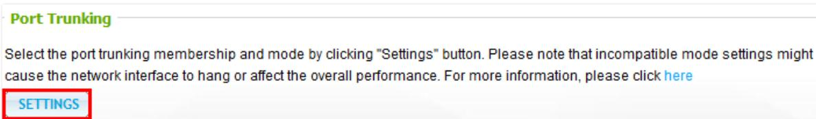
2. Выберите сетевые интерфейсы для группового транкинга (Ethernet 1+2, Ethernet 3+4, Ethernet 5+6, или Ethernet 7+8). Выберите режим транкирования портов из выпадающего меню. Опция по умолчанию - Active Backup (Failover).
