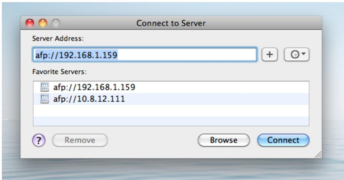
**Примечание:** Mac OS X поддерживает и Apple Filing Protocol, и Microsoft Networking. Для подключения к NAS через Apple Filing Protocol, адрес сервера должен начинаться с 'afp://'. Для подключения к NAS через Microsoft Networking, пожалуйста, используйте 'smb://'.
