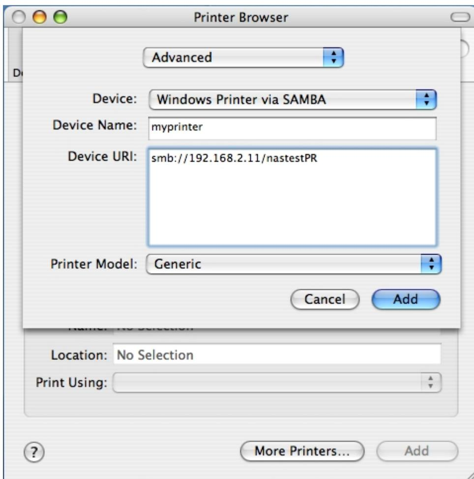
\*Нужно нажать и удерживать клавишу alt с одновременным нажатием «More Printers» (Дополнительные принтеры) для просмотра дополнительных параметров принтера. Иначе данная опция не появится.
