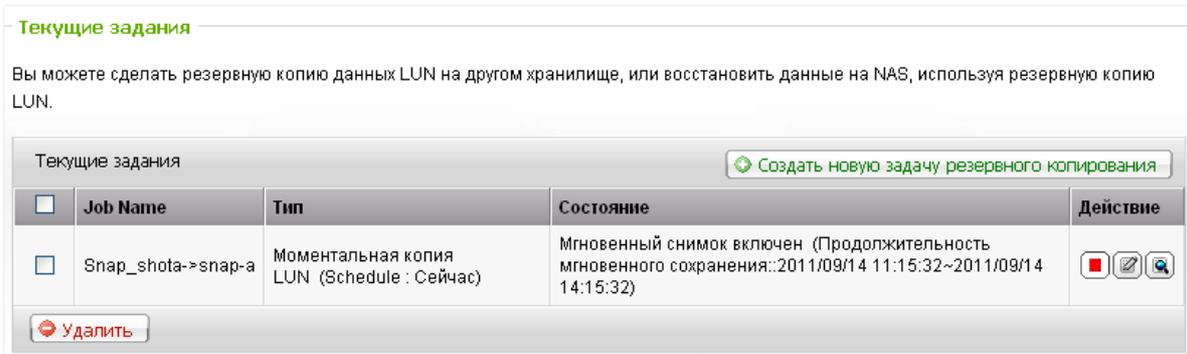
9. Перейдите по "iSCSI" (Цель iSCSI) > "Target Management" (Управление целью), моментальный снимок LUN будет отображен в списке целей iSCSI. Используйте iSCSI инициатор программного обеспечения для подключения к цели iSCSI и доступа к данным точки отката моментального снимка LUN. Для информации о подключении к цели iSCSI на сетевом накопителе от QNAP, пожалуйста, перейдите по [http://www.qnap.com/pro\\_application.asp?ap\\_id=135](http://www.qnap.com/pro_application.asp?ap_id=135).
