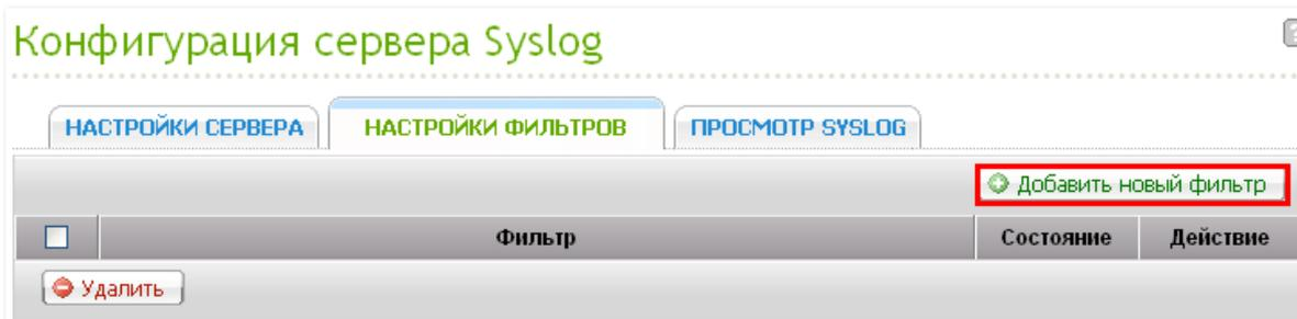
2. Задайте настройки фильтра и нажмите "Add" («Добавить»). Для редактирования фильтров или добавления фильтров вручную, нажмите "Manual Edit" («Редактировать вручную») и измените содержимое диалога. Нажмите "Apply" («Применить») для сохранения фильтра.
