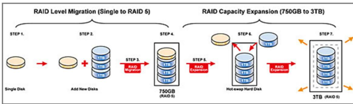
Выполните онлайн миграцию уровня RAID-массива для перевода системы с однодисковой конфигурации на конфигурацию RAID 5. Общая доступная емкость составит 750 Гб в конфигурации RAID 5 (с одним 250-Гб жестким диском и тремя 1-Тб жесткими дисками, диски будут использоваться в конфигурации 250 Гб\*4 для RAID 5). Порядок действий приводится в соответствующем разделе выше.
