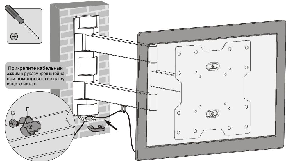
Подсоедините телевизионные кабели к ТВ и проложите их через кабельный зажим и кабельный канал; затем установите кабельную крышку на кабельный канал, чтобы зафиксировать кабель на месте.
