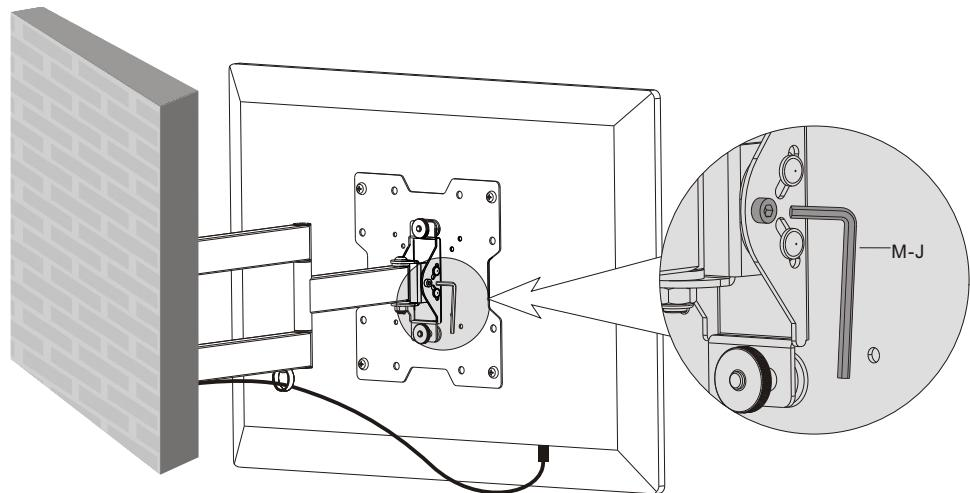
Необходимо слегка ослабить или затянуть регулировочный винт с помощью прилагаемого шестигранного ключа, в зависимости от веса дисплейной установки.
