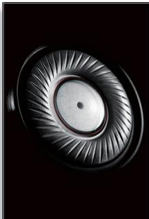
Неодимовые излучатели реагируют на все колебания звука. Конструкция с прорезью в центре усиливает звучание средних и низких частот и вырабатывает акустическую энергию, обеспечивающую более полное и при этом контролируемое звучание басов и чистый среднечастотный диапазон. Излучатели оснащены легкой звуковой катушкой, обеспечивающей быстрый отклик системы в соответствии с темпом музыки и звук высокой четкости.
