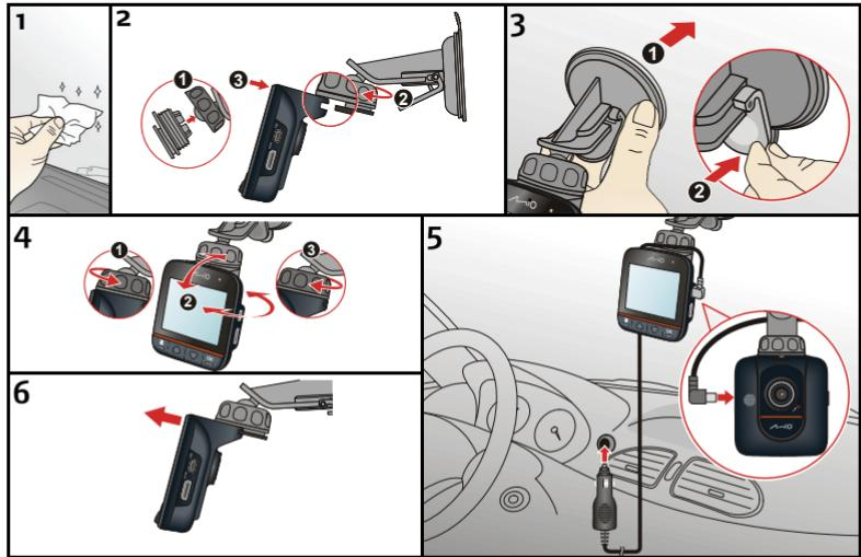
С помощью кабельных фиксаторов закрепите кабель питания, чтобы он не мешал во время вождения. Для обеспечения наилучшего качества записи рекомендуем расположить устройство рядом с зеркалом заднего вида.
