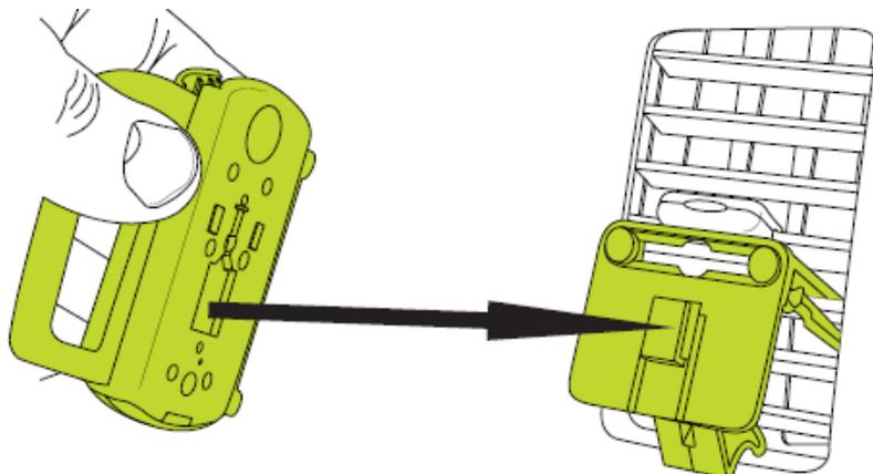
Присоедините держатель к зажиму для вентиляционной решетки путем насаживания прорези держателя на выступ зажима и сдвиньте его вниз.
