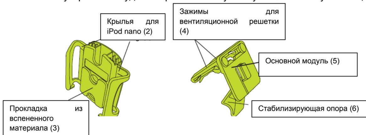
Для iPod nano прикрепите дополнительные более мелкие крылья к основной части. Приложите прокладку к основной части, предварительно удалив липкую заднюю пленку с прокладки, и крепко прижмите ее к основной части держателя.
